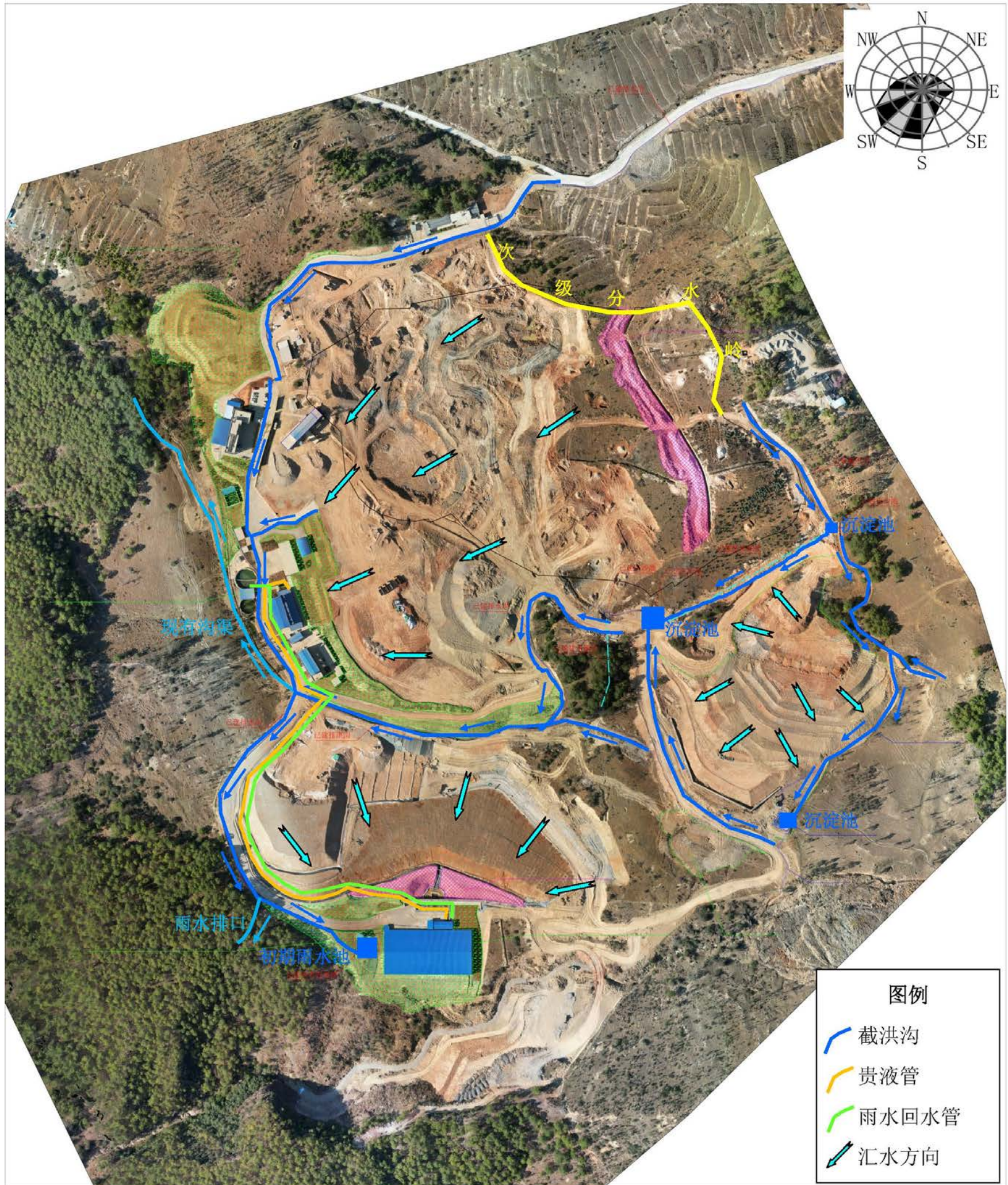
附图七：雨污水管网图
