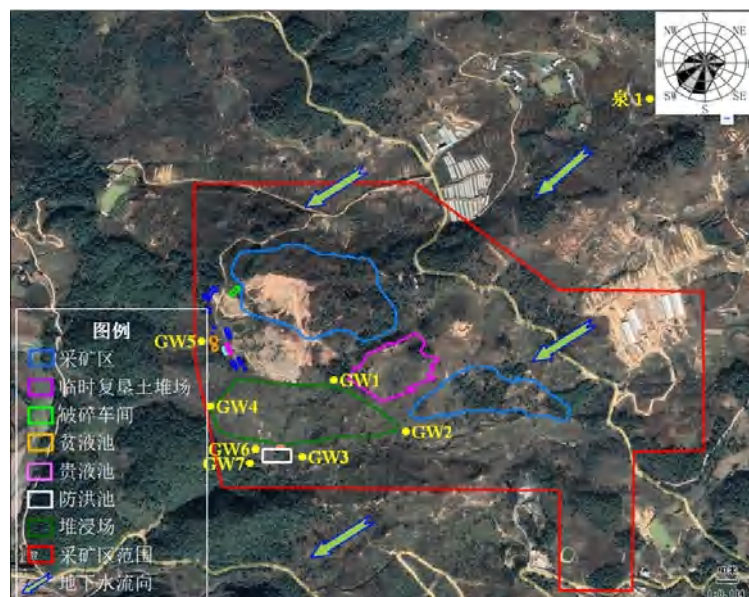
地下水监测井位置
